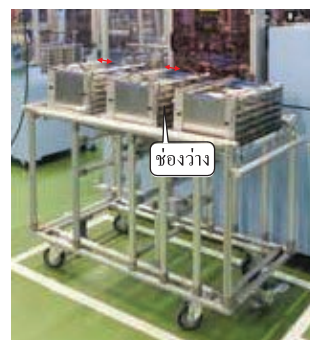
รถเข็นคาราคุริที่ออกแบบโดยคำนึงถึงคุณภาพของชิ้นงาน โดยป้องกันการชนกัน
