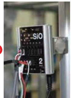
5) ภาชนะบรรจุจะเคลื่อนที่ในแนวอนตาม Walking Slider และไหลไปตามทางโดยอัตโนมัติ โดยใช้ SiO ในการควบคุม
