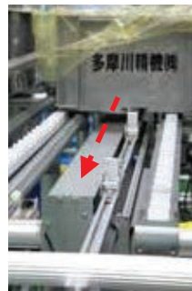
5) ภาชนะบรรจุจะเคลื่อนที่ในแนวอนตาม Walking Slider และไหลไปตามทางโดยอัตโนมัติ โดยใช้ SiO ในการควบคุม
