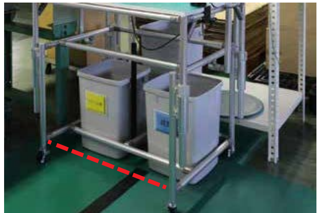
ก่อนหน้านี้ เฟรมอุปกรณ์ที่ตำแหน่งเส้นประสีแดง แต่มีความเห็นว่า หากเลื่อนเข้าไปด้านในจะทำให้ทำงานได้ง่ายกว่า จึงได้ทำการปรับเปลี่ยน
