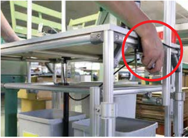
เมื่อโยกกันโยกที่ปลายโต๊ะก็จะลดหรือเพิ่มระดับความสูงได้ เสียก็เบาไม่รบกวนการทำงานของคนรอบข้าง
