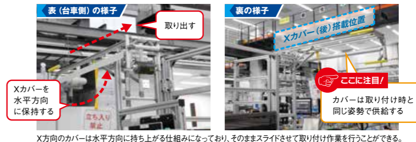
X方向のカバーは水平方向に持ち上がる仕組みになっており、そのままスライドさせて取り付け作業を行うことができる。
