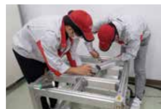
架台の製作・組み替え
