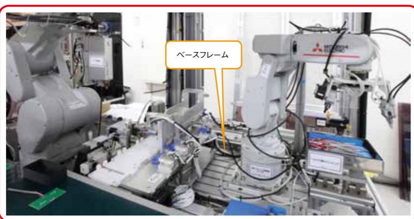
ケーブルの被覆をむき、端子をかしめるデモ装置。ロボットや各種機械が取り付けられた天板にはベースフレームが使われている。
