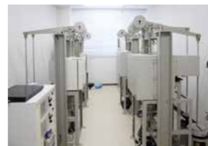
高温下でわずかな力をかけ続けた際の変形を調べるクリープ試験機。自動車用の素材開発などで使用されている。
