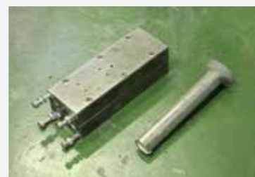
マグネシウムと添加元素を溶かして固める小型溶解装置用の鑄型(左)と鑄造された合金(右)。
