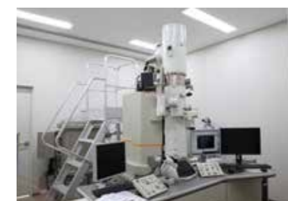
原子レベルでの観察が可能な電子顕微鏡によって、合金の構造が明らかにされてきた。研究棟には合計5台の電子顕微鏡が設置されている。
