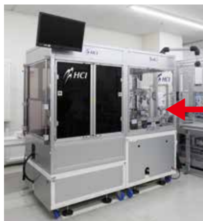
ケーブルの被覆をむき、端子をかしめるデモ装置。ロボットや各種機械が取り付けられた天板にはベースフレームが使われている。
