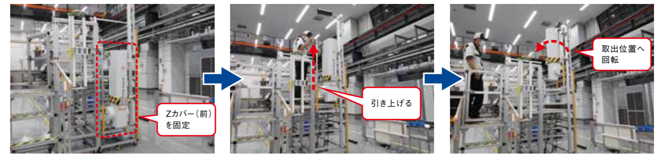
大きなカバーを持って階段を昇らなくてよいよう、取り付けられたエレベータ機構。ウェイトとのバランスにより持ち上げる際の負荷も軽くしている。
