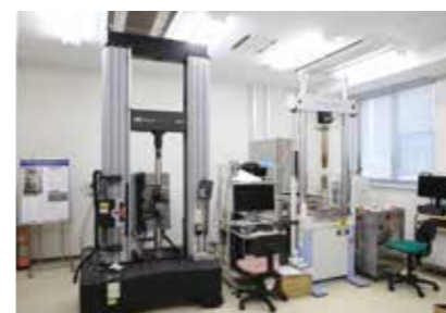
素材の強度を調べる試験機。航空機用のデータを取る際は試験機のメーカーまで指定されているとのこと。
