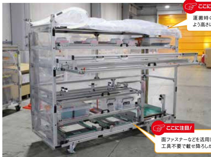
傷を付けず、簡単に効率よく部品を積載できるよう、工夫を凝らした出荷台車。
