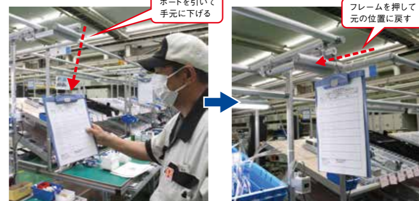
いちいち取り外さなくとも、手元に引き寄せて記入が可能な生産管理板。板は引いた位置で止まり、フレームを押し上げ簡単に上へと戻る。
