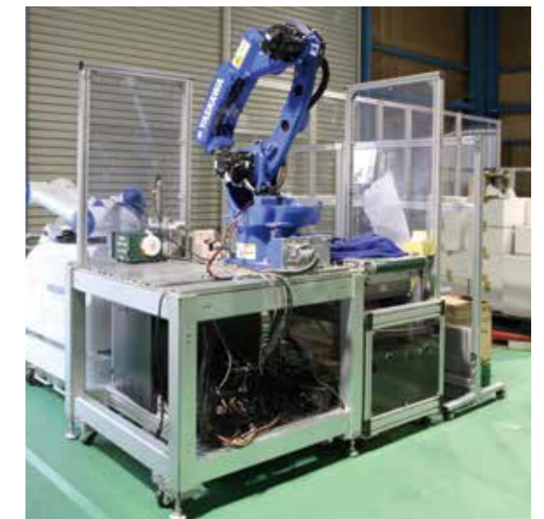
ZFを架台に使い、多関節ロボットを載せたロボットシステムのデモ装置。
