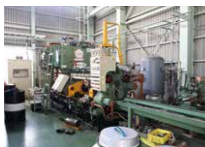
加工実験棟に設置された押出機。視察に訪れた企業が驚くほど、モノづくりの設備も充実している。
