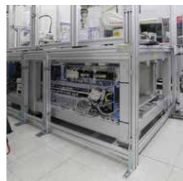
ラボに展示されているデモ機の1つ。カバー内部にZFで組まれた架台が見える。
