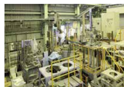
溶解鑄造の様子。2006年のプログラムでは一度に400kgのマグネシウムを扱える大型の溶解炉で量産の条件出しが行われた。
