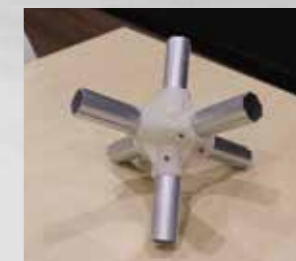
3Dプリンタで試作した 6Wayコネクタ。
