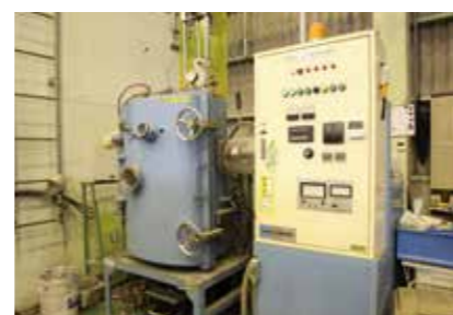
300g程度の合金作成に使う「小型真空溶解装置」。均一に混ぜるため攪拌装置をつけるなど、独自設計の工夫が凝らされている。
