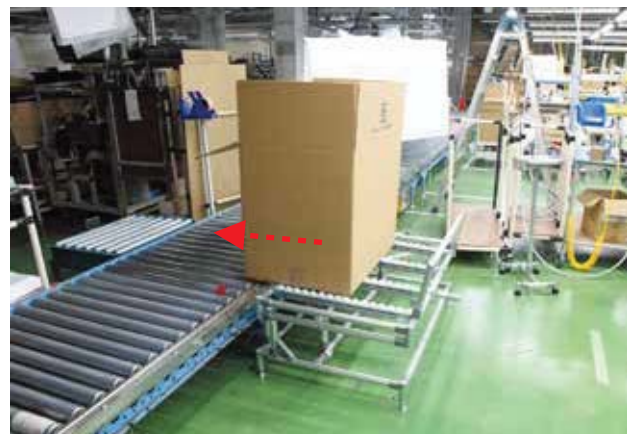
SeeSaw Table : อุปกรณ์จะเอียงมาฝั่งผู้ปฏิบัติงานเพื่อบรรจุเก้าอี้ที่ประกอบเสร็จ และเมื่อบรรจุลงหีบห่อเรียบร้อยแล้วทำการดันขึ้นกล่องก็จะไหลไปด้านหลังได้อย่างง่ายดาย
