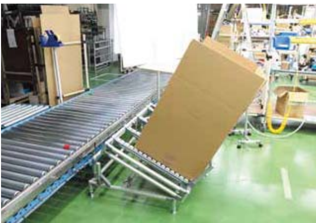
SeeSaw Table : อุปกรณ์จะเอียงมาฝั่งผู้ปฏิบัติงานเพื่อบรรจุเก้าอี้ที่ประกอบเสร็จ และเมื่อบรรจุลงหีบห่อเรียบร้อยแล้วทำการดันขึ้นกล่องก็จะไหลไปด้านหลังได้อย่างง่ายดาย
