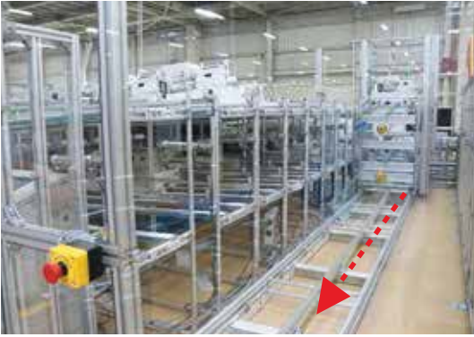
ผลิตภัณฑ์ที่ไหลจะแยกเรียงตามหมายเลขผลิตภัณฑ์โดยอัตโนมัติ
