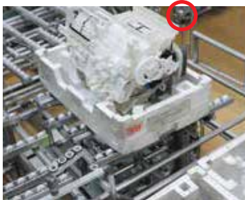
① เซนเซอร์ตรวจจับชิ้นงานที่ไหลเข้ามาในเทเบิล
