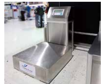
取材の直前に納品された重量計の試作品。元々使用していた既製品の量りをベースにしている。
