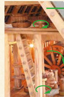
水車の動力は歯車を介して2階へ伝えられ、また別の動きに変換される。
