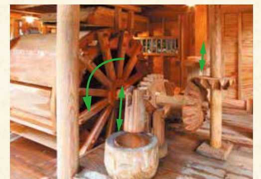
水車の軸に取り付けられた木が杵の柄に当たることで、杵が上下に動く仕組み。
