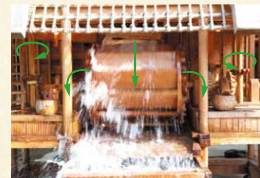
水磨様は、巨大な水車を中心に左右対称のつくりになっており、1つの水車で多くの仕組みを動かしている。
