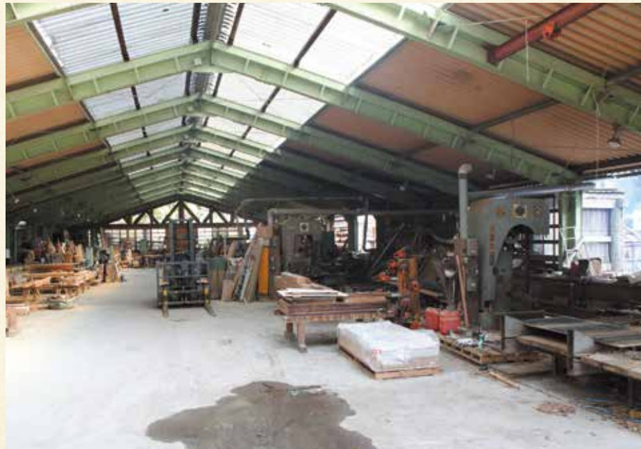
天城カントリー工房の作業場。材料の買い付けから製材・乾燥・加工・現場施工まで、すべてを自社内で行っている。
