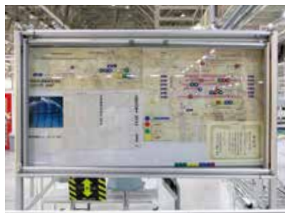
掲示板に飾られているのは、工場内の改善実施箇所を示した、ものづくりMAP。“同期台車”“からくり”“シューター”など、種類に応じて色分けした磁石を工場の見取り図上に載せており、その数は徐々に増えている。
