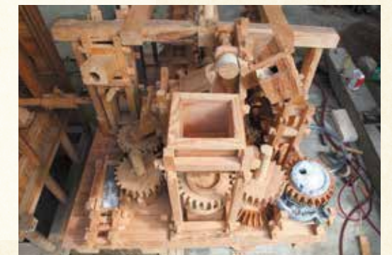
水磨様の完成後、水車の動力をもっと活用したいと追加された仕掛け。
