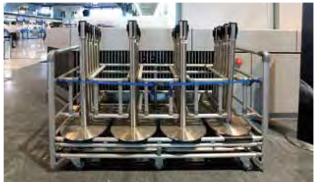
เนื่องจากเสาทะก้นจะเอียงเมื่อวางแบบซ้อนกัน เพื่อไม่ให้ล้มจึงคิดเฟรมที่ค้ำส่วนเส้าไว้
