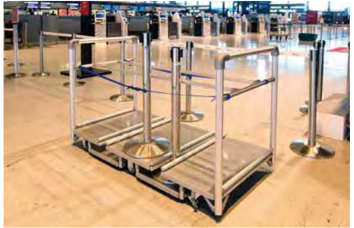
สำหรับเสาเทปกั้นแบบวางซ้อนกันไม่ได้ นั้น ระดับความสูงของฐานรถเข็นจะต่ำกว่าที่วางโดยรถเข็น 1 คัน สามารถวางเสาเทปกั้นได้ระหว่างกันได้ 10 เสา
