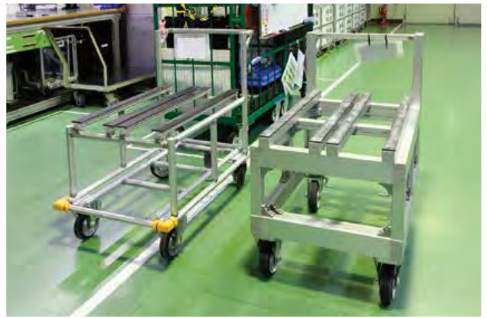
รถเข็น GF(ซ้าย) และรถเข็น SF(ขวา) ที่ใช้งานจริงในกระบวนการผลิต ซึ่งรถเข็น GFเป็นอุปกรณ์ที่ ขอให้ SUS ทำการประกอบและได้รับการปรับให้ดีขึ้น สามารถรองรับน้ำหนักได้ 320 กิโลกรัม
