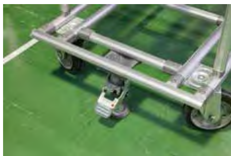
มีการติดตั้งตัว Stopper เข้ากับรถเข็นทุกตัวป้องกันการเคลื่อนที่ เพื่อความปลอดภัย
