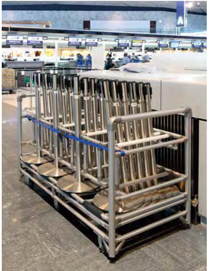
รถเข็นรุ่น GF ที่ใช้งานอยู่ในล้อบีขาออก (ปีกกิดได้) ของอาคารผู้โดยสาร 1 ตัวฐานสามารถ รองรับการวางเสาทะก้นแบบวางซ้อนกันได้ 20 เส้า
