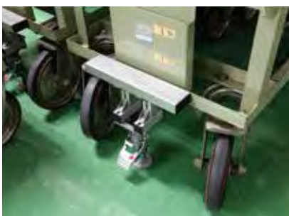
มีการติดตั้งตัว Stopper เข้ากับรถเข็นทุกตัวป้องกันการเคลื่อนที่ เพื่อความปลอดภัย
