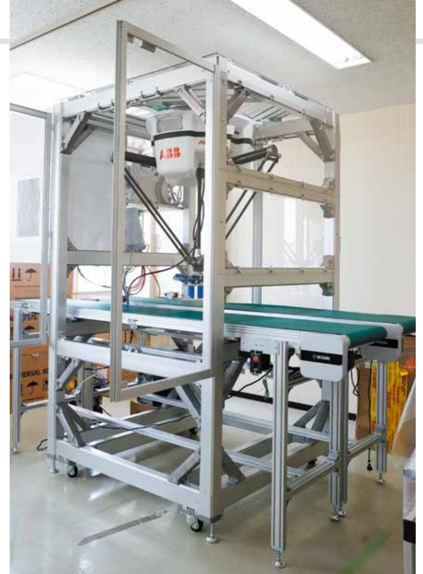
現在も食品産業での活用が多いパラレルリンクロボットには、架台にZFを用いたABB社製の「FlexPicker オールインワン」を採用。
