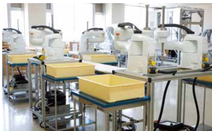
実際に使用する環境に近付けるため、周辺機器も合わせて導入。お弁当のパッキングを想定したテスト用には、コンベヤの両脇に水平多関節ロボットを揃えた。
