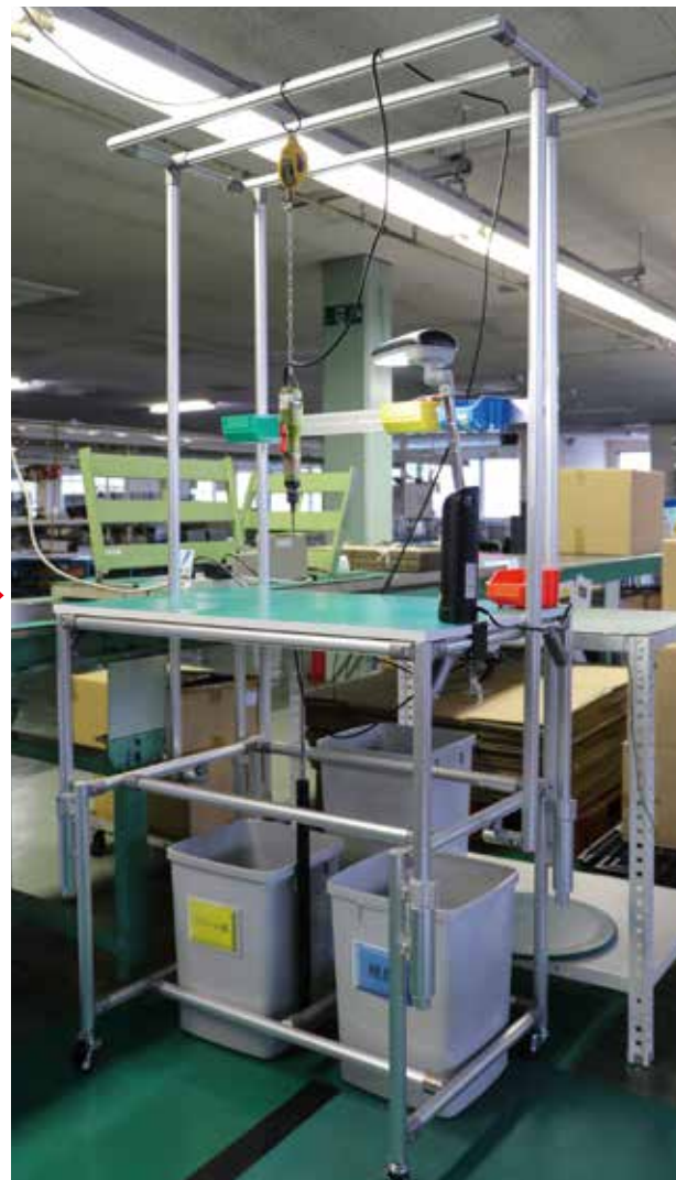
電動ドライバーやパーツコンテナの保持ができる棚を取り付けたタイプ。標準の作業台をベースにカスタムが可能なのも魅力。
