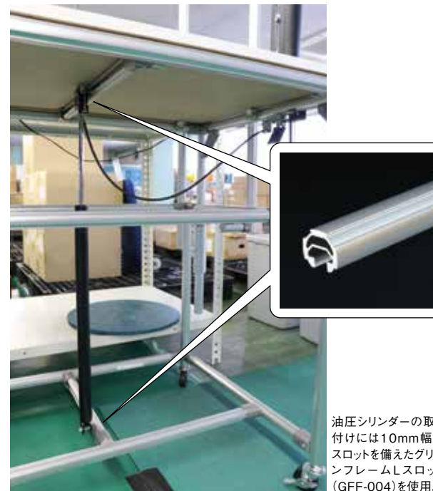
作業台の高さを調整し、ネジを締める位置のすぐ近くまで持ち上げることで、最小限の動作での組立が可能になる。
