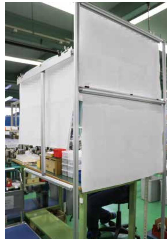
以前は机の上に広げていた図面を留め、既存の作業台と合わせて使う簡易的なラック。1面タイプ(左)と2面タイプ(右)があり、現場のアイデアから生まれた。
