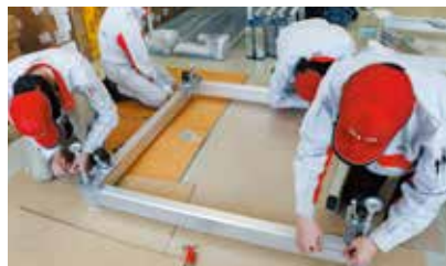
まずは足元の四角いフレームを組み立て、キャスターとアジャスタを取り付ける。
