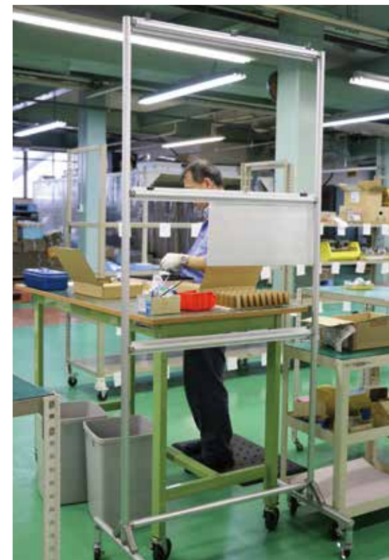
以前は机の上に広げていた図面を留め、既存の作業台と合わせて使う簡易的なラック。1面タイプ(左)と2面タイプ(右)があり、現場のアイデアから生まれた。
