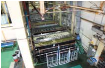
アルマイトライン。鉄道車両の窓枠や広告を掲示するための枠、新幹線N700系グリーン車の中木、またエレベータの接触棒などの表面処理を行っている。実際には白（普通）アルマイトではなく染色アルマイトで、白色に近い微妙なカラーリングを施す。処理の前にバフ研磨することがほとんどとのこと。
