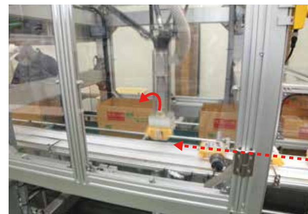
箱詰めはパラレルリンクロボットが得意とする作業。ロボットのハンドで吸着された製品が箱の中に整然と詰められていく。
