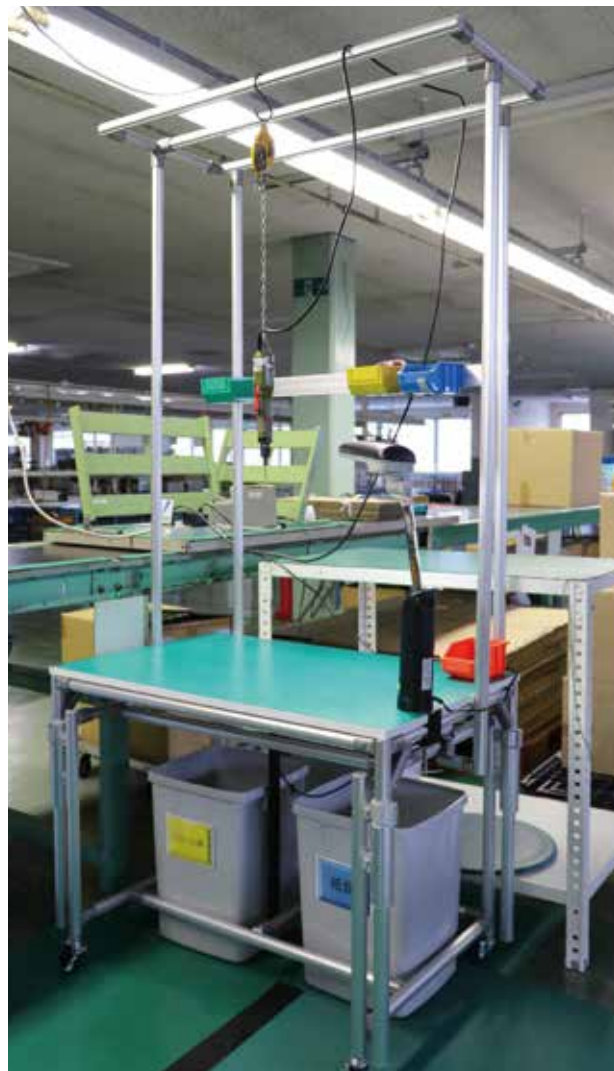
電動ドライバーやパーツコンテナの保持ができる棚を取り付けたタイプ。標準の作業台をベースにカスタムが可能なのも魅力。
