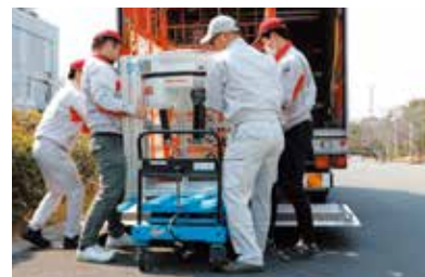
2tトラックで運んだ昇降機能付きの台車にロボットを治具ごと載せ換える。
