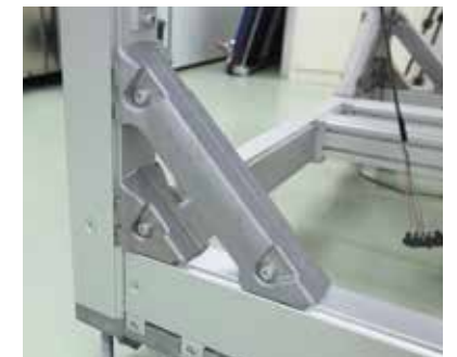
補強に用いるコーナージョイントとステイコネクタPBは、どちらも簡単に後付けが可能。
