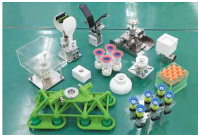
ワークに合わせて試作されたハンドの数々。既製品との組み合わせや3Dプリンターなども用い、お客さまの要望を形にいく。
