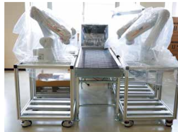
中央に置いた食洗機へ自動で食器を出し入れすることを目指す垂直多関節ロボット。大学生協の厨房とも協力し、実験を進める計画。
